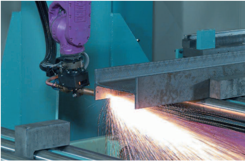
De KC 1201 raveelrobot snijdt als een mes door staal.
